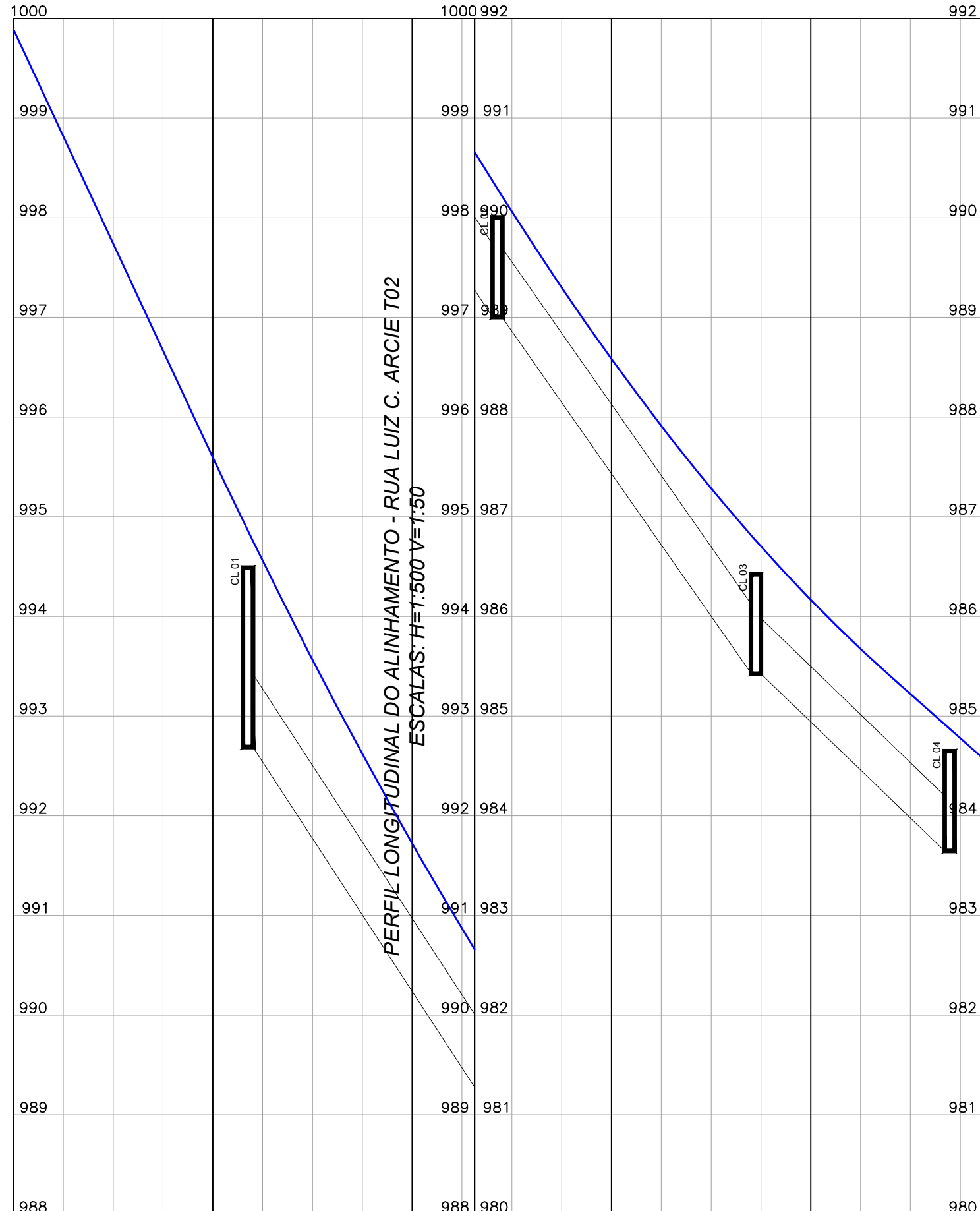
PERFIL LONGITUDINAL DO ALINHAMENTO - RUA LUIZ C. ARCIE T02 ESCALAS: H=1:500 V=1:50
